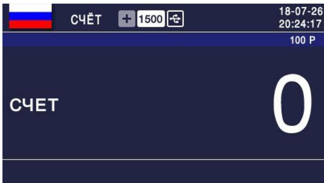
В режиме ПРОСТОЙ СЧЁТ машина пересчитывает количество банкнот. Детекция защитных машиночитаемых признаков и определение номинала банкнот в этом режиме отключены. Проверяется только сдвоенность банкнот.
